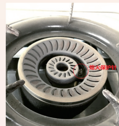
注：压电点火型，一根铜针
